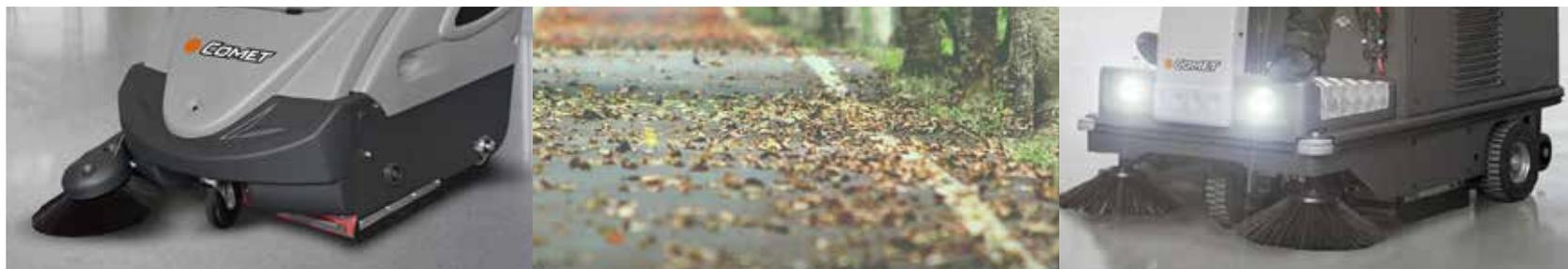
Le spazzatrici hanno un **sistema di pulizia meccanico-aspirante**: due spazzole laterali convogliano lo sporco verso una spazzola centrale e una turbina aspirante rifiuti e polvere: i primi finiscono nel contenitore, mentre la polvere viene filtrata e intrappolata senza tornare in ambiente.
