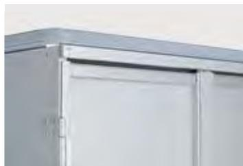
Ante spessore 2,5 mm ripiegate con profili di rinforzo saldati in alto e in basso.
