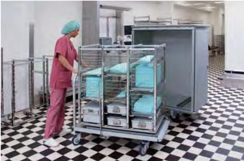
Il sistema Shuttle è la soluzione ideale per garantire la protezione dei prodotti sterilizzati durante il trasporto esterno. Nella zona di confine durante il trasferimento della navetta dall'armadio al carrello di trasporto viene garantita l'assenza di contaminazione.
